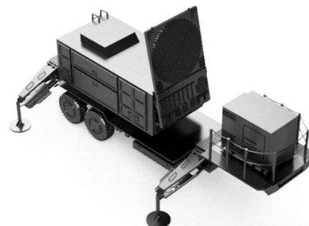
**Vorbildbeschreibung:** Bei der ersten Ausführung der MIM-104 kommt das AN/MPQ-53-Multifunktionsradar zur Anwendung. Dieses dient zur Erfassung, Identifizierung und Bekämpfung von Luftzielen. Es verwendet eine Phased-Array-Antenne mit 5161 Phasenschiebern und funktioniert nach dem Prinzip der passiven, frequenzgesteuerten Phased-Array-Antennen (PESA).
